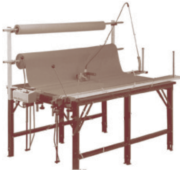
KSM ECS 40 – półautomatyczny system nakładu.
